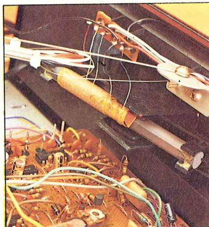
*L'antenna per l'AM è posta internamente: la sua orientazione è possibile solo in senso orizzontale.*
